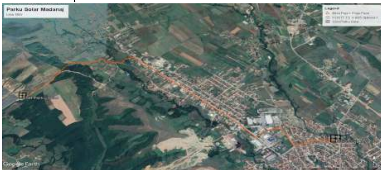
Figure 6. Linja nëntokësore 35kV nga Parku Solar Madanaj deri te NS 110/35 GJ 1 KOSTT
