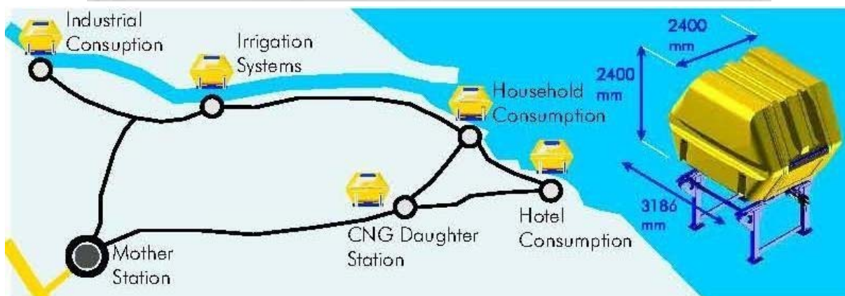
Figura 39 Skema e funksionimit të sistemit CNG-së
