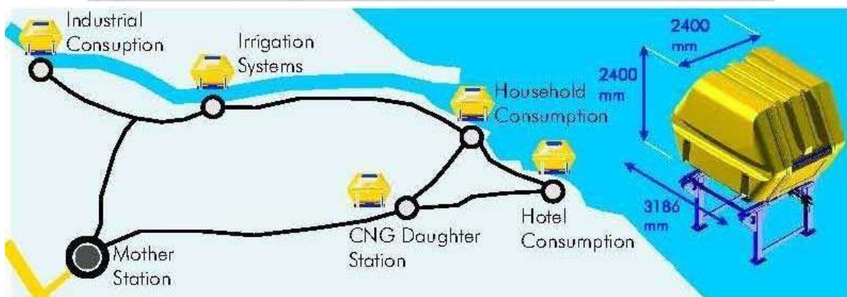
Figura 38 Skema e funksionimit të sistemit CNG-së
